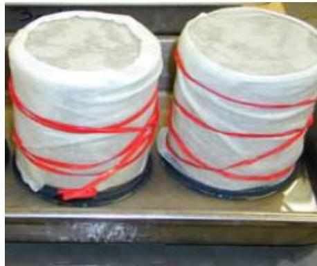
Figura 605 - 1. Saturación de las probetas por capilaridad
