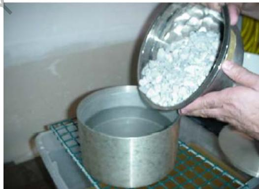
Figura 242 - 21. Adición de la muestra al picnómetro
