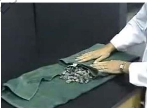
Figura 223 - 2. Secado superficial de la muestra
