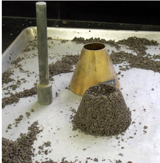
Figura 222 - 3. Agregado con humedad superficial
