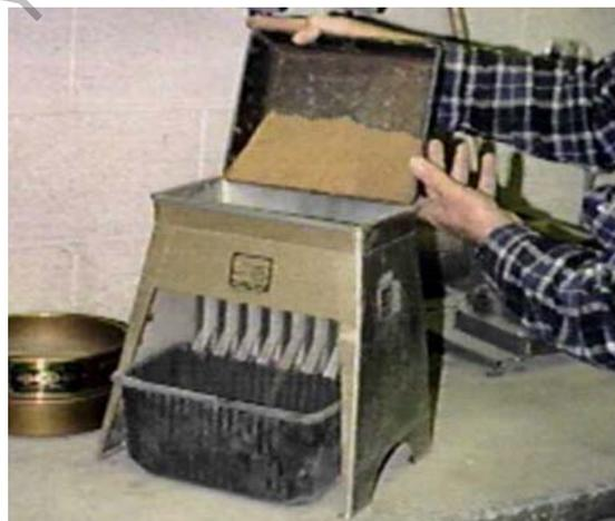
Figura 202 - 3. Distribución del agregado en la canaleta alimentadora
