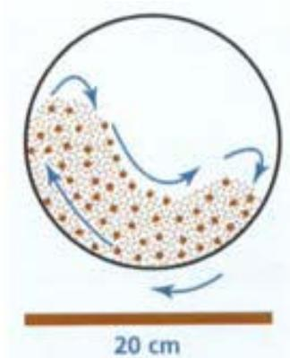
Figura 238 - 1. Degradación del agregado durante el ensayo Micro-Deval
