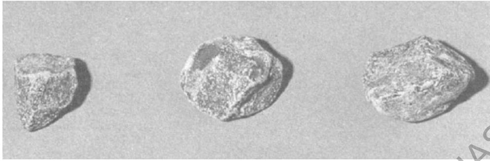
Figura 227 - 4. Partículas fracturadas (bordes redondeados, superficies rugosas)
