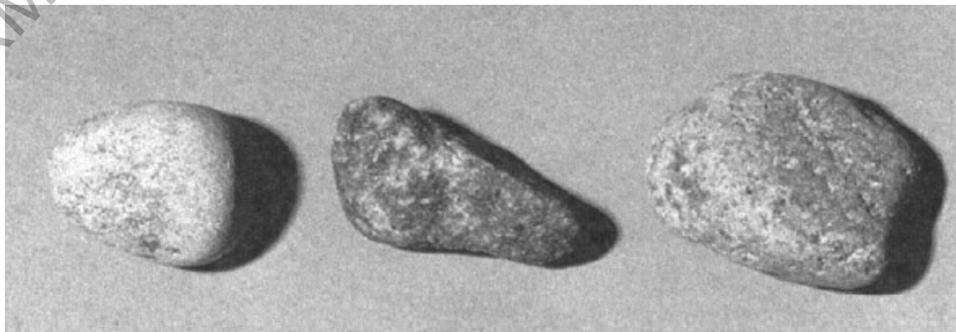
Figura 227 - 7. Partículas no fracturadas (partículas redondeadas, superficies lisas)
