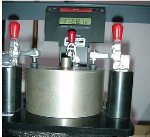
Figura 242 - 5. Pesaje del picnómetro lleno de agua
