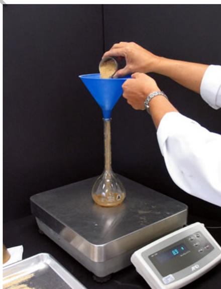
Figura 222 - 4. Introducción de la muestra en el picnómetro
