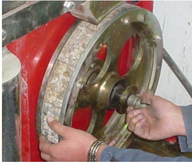
Figura 232 - 7. Instalación de la rueda porta-probetas
