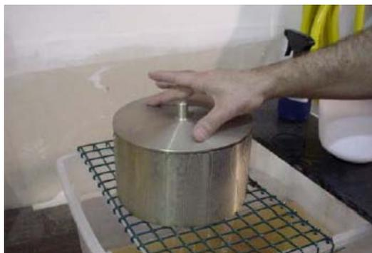
Figura 242 - 7. Colocación de la tapa sobre el picnómetro
