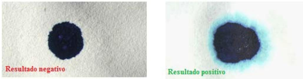
Figura 235 - 1. Resultados negativo y positivo en el ensayo de coloración
