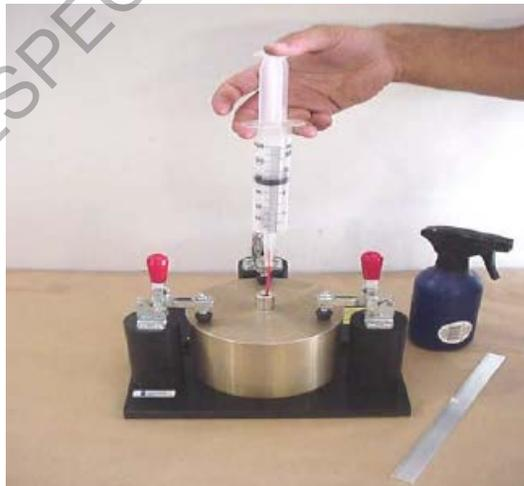
Figura 242 - 4. Uso de la jeringa para completar el llenado del picnómetro pequeño con agua
