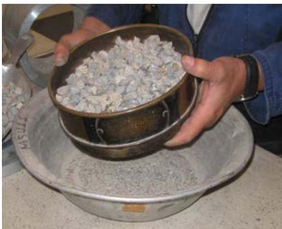
Figura 224 - 5. Tamizado sobre el tamiz de 2.36 mm (No. 8)
