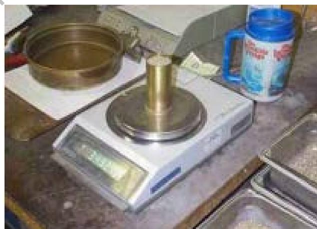
Figura 239 - 4. Determinación de la masa del recipiente con el agregado fino
