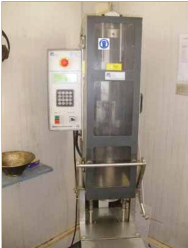
Esta norma no es un procedimiento de ensayo; únicamente se refiere a un método de preparación de probetas para su posterior medición y/o ensayo (Marshall, rigidez, tracción indirecta, compresión simple, etcétera), y es, por ello, la importancia de efectuar correctamente estas operaciones.
